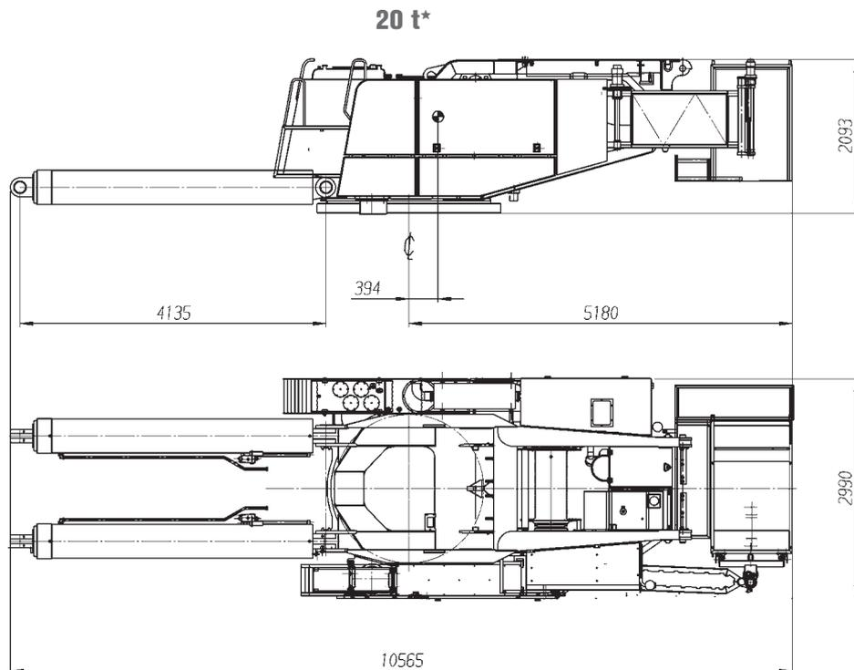
\* incl. luffing cylinder · inkl. Wippzylinder · avec vérin de relevage · incl. cilindro di impennatura · incl. cilindro de elevación · Incl. pistão elevatório · Вкл. цилиндр управления вылетом стрелы
